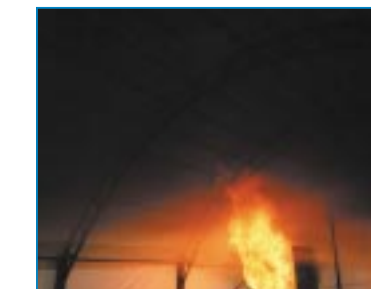
Temps 1 : embrasement, formation d'un trou dans la toile.
